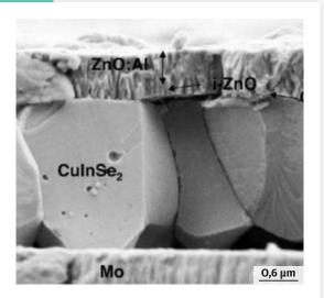
Les procédés de fabrication des cellules CIGS permettent de fabriquer de relativement grandes surfaces sur des substrats rigides ou flexibles. Les matériaux de film mince peuvent absorber très efficacement les photons et seuls quelques micromètres d'épaisseur sont nécessaires contre 200 µm pour leurs homologues cristallins à base de silicium.
