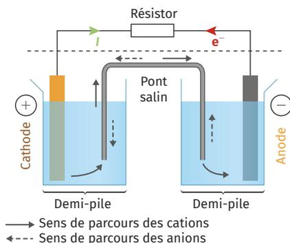
Une pile produit de l'électricité à partir d'une réaction d'oxydoréduction qui met en jeu un échange d'électrons.
